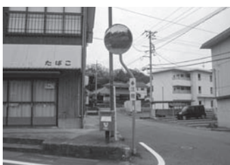
カーブミラーの設置
