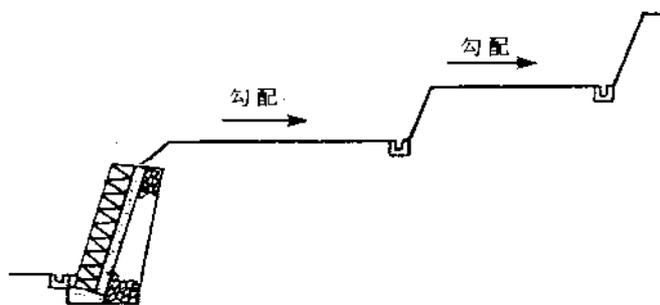
図 6.1 がけの上端に続く地盤面の水勾配
