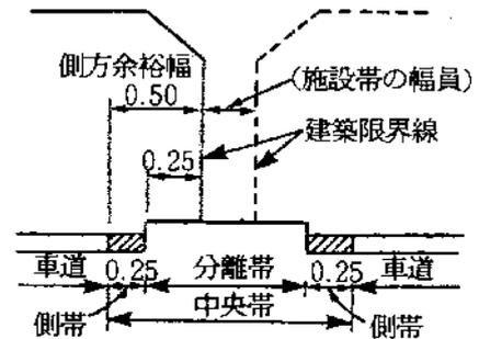
図3.10 中央帯の幅員構成
