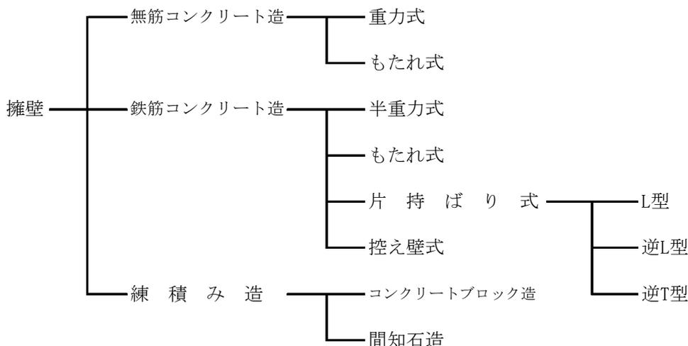
擁壁の設置にあたっては、設置箇所の地形、土質、地下水等の自然的条件、施工条件、周辺の影響及び擁壁高さ等を十分に調査、把握し、高さに応じた適切な材料及び形状のものを選定するものとする。さらに維持管理面から将来にわたって安全が確保できるか十分に検討する必要がある。特に直高 5m を超える擁壁については、土質等の調査に基づき、安定性、応力解析等について綿密に検討しなければならない。
