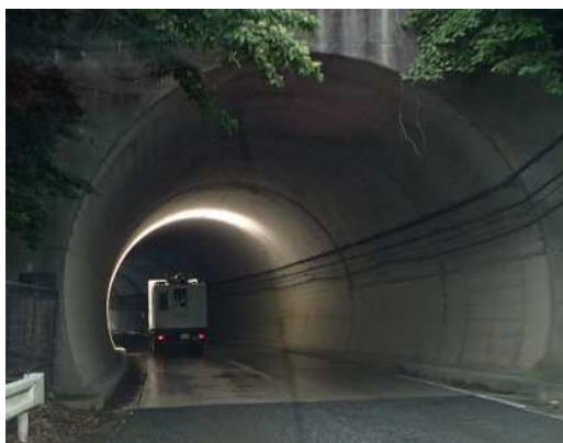
走行型 3D トンネル点検システム
