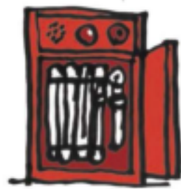
屋内消火栓設備
