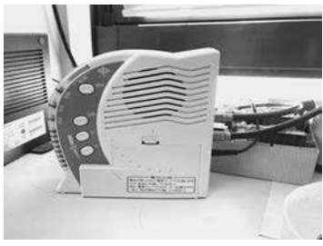
大田市で設置されている戸別受信機
