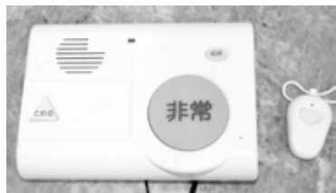
緊急通報装置の一例
